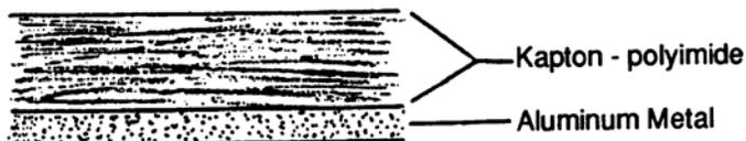
Les "Second-surface mirrors" au Kapton (Polyimide) sont aussi très populaires. Comme pour le Téflon, l'épaisseur de Kapton définit l'émissivité qui augmente avec l'épaisseur. L'Aluminium est toujours utilisé comme miroir métallique. Le Kapton a une couleur orange par transparence. La densité de couleur augmente avec l'épaisseur ainsi que  $\alpha$  et aussi  $\epsilon$  de sorte que  $\alpha/\epsilon$  reste constant  $\approx 0.5$ .
